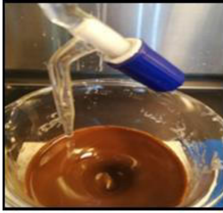
الشكل (11-3) مرحلة التقطير لهيدروكسيد الصوديوم على الخليط
