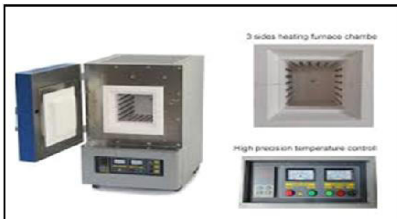
الشكل (2-3) فرن الحرق المستخدم في تحضير المسحوق .
